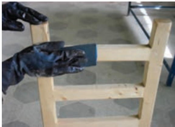
شکل ۶-۱۲- پوست آب کاری روی سطح سیلر فورده.
