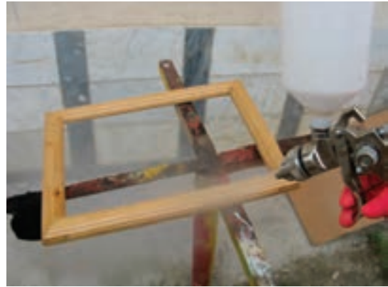
شکل ۱۸-۱۲- (زدن نیم پلی استر با پیستوله).
