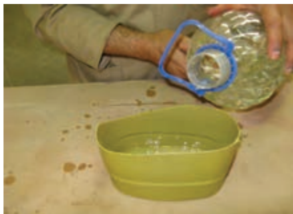
شکل ۸-۱۲- استفاده از تینر فوری برای رقیق کردن سیلر.
