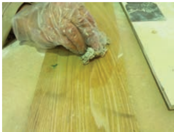
شکل ۴۶-۱۲- زدن آستری بر روی یک تخته نراد با کهنه رنگ‌کاری.
