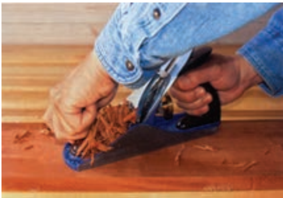
شکل ۲۱-۳- رنده‌کاری سطح چوب.
