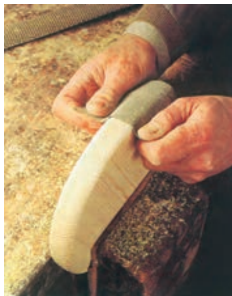
شکل ۲۶-۴ - سنبله‌کاری (روی سطوح قوس‌دار).
