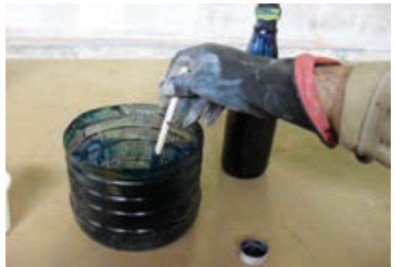
شکل ۵۳-۱۲- مل کردن آب در آستری آب.
