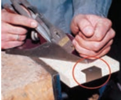
شکل ۳-۳- احتمال برافروخته رنده با میخ و یا اشیاء فلزی.
