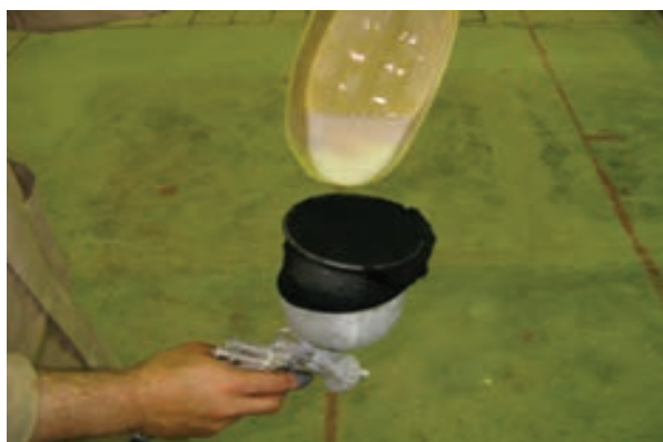
شکل ۵-۹- استفاده از جوراب نازک به عنوان صافی.
