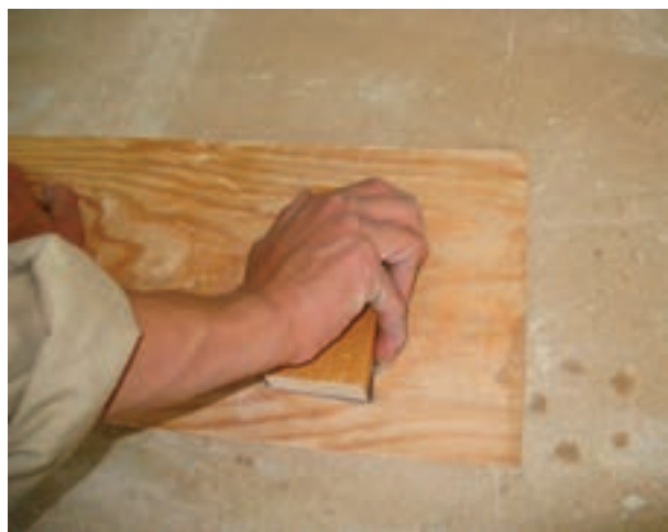
شکل ۱۵-۱۳- سنباده‌کاری در فلاف جهت الیاف.
