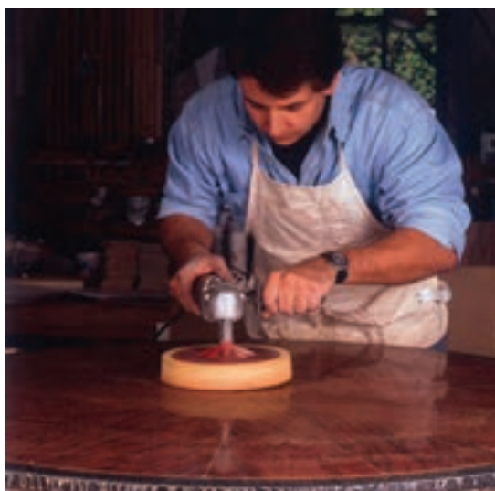
شکل ۱۲-۲۴- پولیش‌کاری سطح پلی استر فورده.
