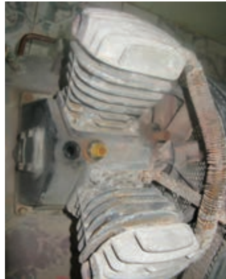
شکل ۸-۷- مفزن (روغن یک کمپرسور دو سیلندر).
