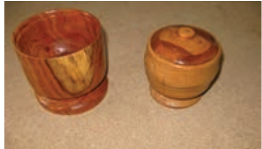
شکل ۱-۱۲- در رنگ غیرپوششی الیاف و نقوش چوب، از زیر رنگ به خوبی دیده می‌شود.
