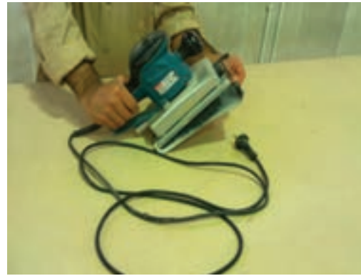
شکل ۱۸-۵- نمونه تعویض ورق سنباده لرزان.
