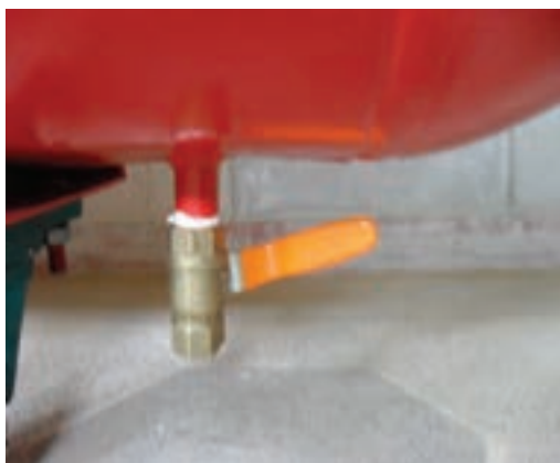
شکل ۴۵-۱۳- شیر تخلیه کمپرسور.
