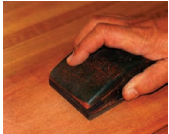
شکل ۲۰-۴- پوست آب کاری به کمک تخته پوست.
