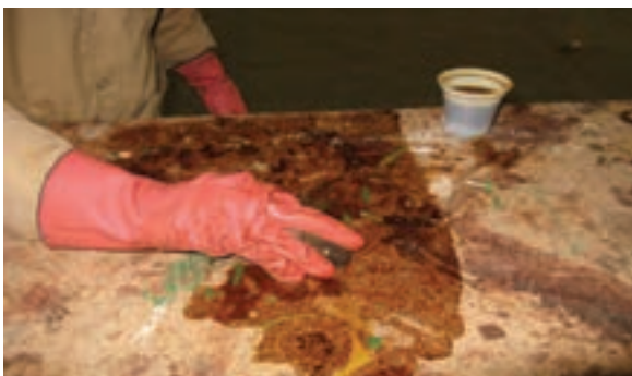
شکل ۱۲-۱۰- استفاده از کهنه رنگ‌کاری برای نفوذ بهتر روغن بزرک.
