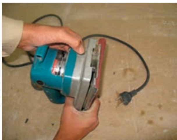
شکل ۲۶-۱۳- وصل کردن سنباده نو به کمک گیره‌های عقب و جلوی دستگاه.
