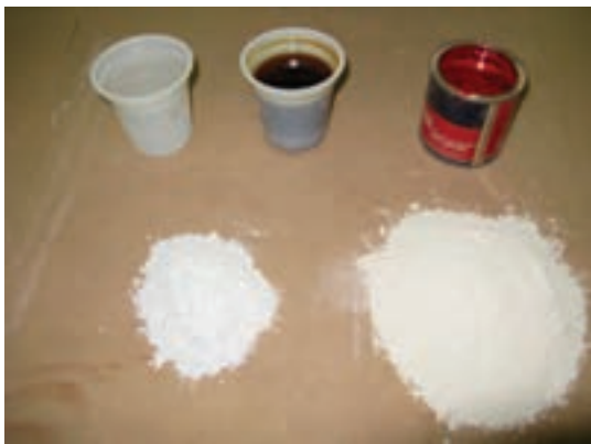
شکل ۲۲-۶- مواد تشکیل دهنده بتونه روغنی.
