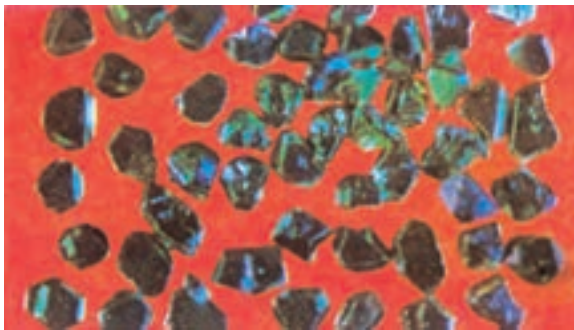
شکل ۸-۴ - دانه‌بندی اکسید آلومینیوم.
