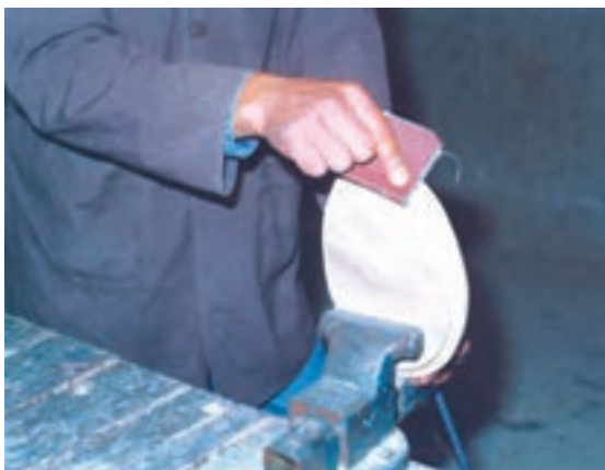
شکل ۲۲-۴- عده استفاده از چوب کمکی.
