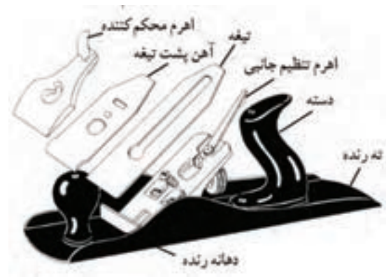
شکل ۳-۵۱- قسمت‌های مختلف رنده دو تیغ آهنی.
