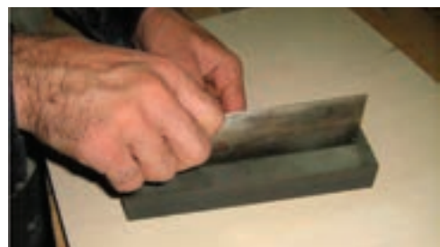
شکل ۳-۴۳- کشیدن لیس روی سنگ نفت.
