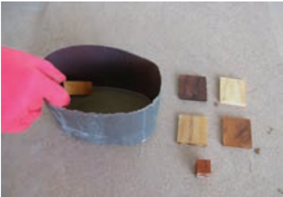
شکل ۶-۱۲- استفاده از روش غوطه‌وری.
