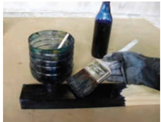
شکل ۵۴-۱۲- زدن آستری آب (روی سطح کار).
