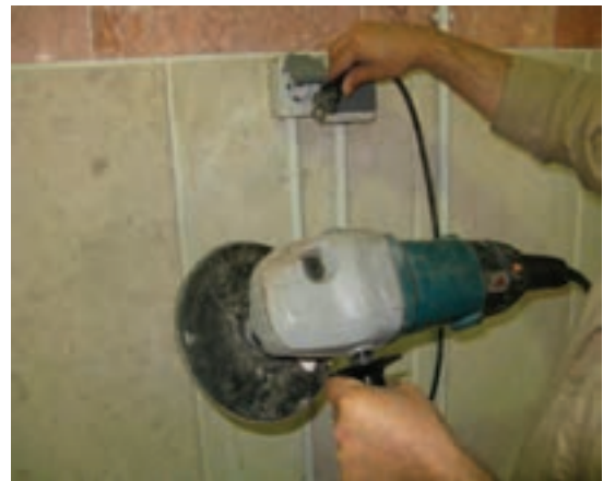
شکل ۲۰-۱۳- کشیدن دوشافه ماشین پوست گرد از پریز.
