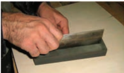
شکل ۱۱-۳- کشیدن لیسه روی سنگ‌نفت.
