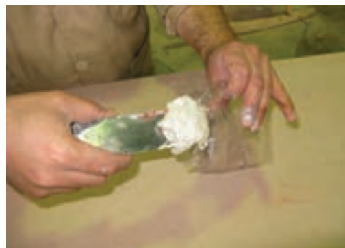
شکل ۳۱۳-۶- قراردادن بتونه سربشی داخل پلاستیک.
