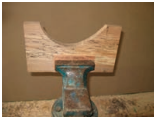
شکل ۱۴-۱۳- سنباده‌کاری یک کار قوس‌دار.
