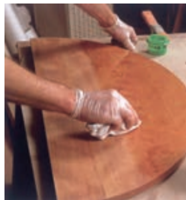
شکل ۳-۳۸- استفاده از پارچه نم‌دار در لیسسه‌کاری.
