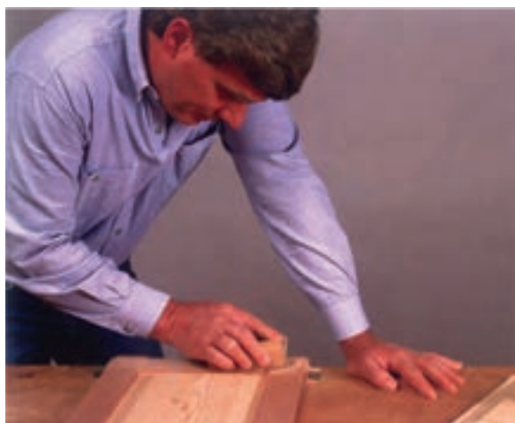
شکل ۳۸-۱۲- زدن آستری گردویی به سطح کار.
