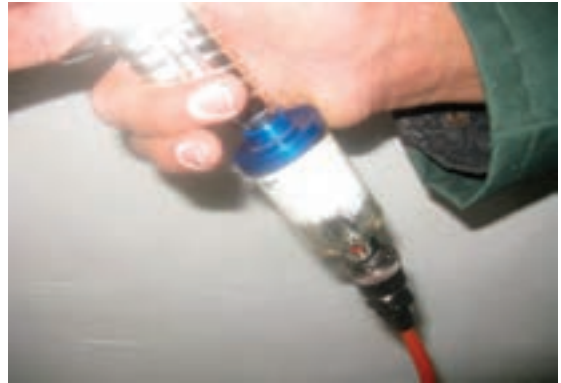
شکل ۲۶-۸- محل اتصال شیلنگ باد به پیستوله.
