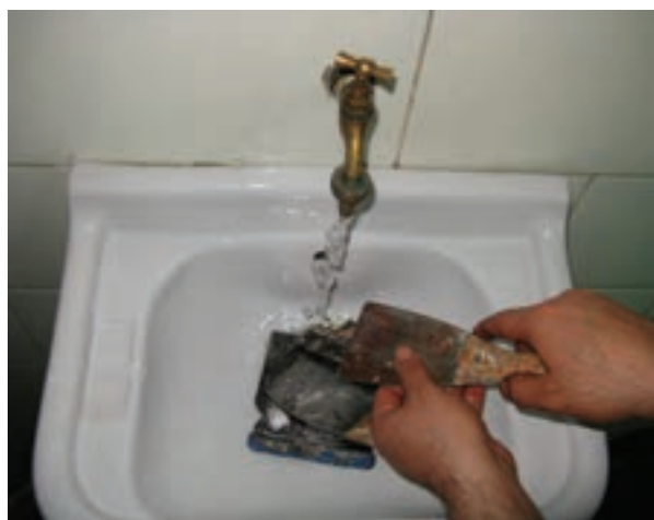
شکل ۱۷-۶- شستن و تمیز کردن لیسسه و کاردک.
