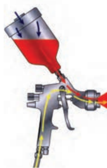
شکل ۱۷-۸- پیستوله کاسه بالا.
