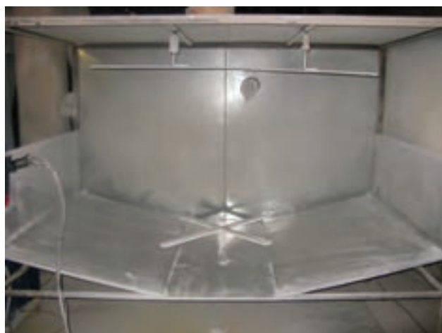
شکل ۳-۹- یک آبشار رنگ با اسکلت فلزی.
